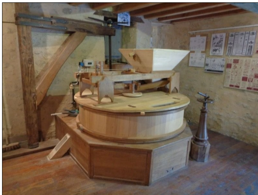
Le 09/10 - Le moulin de Pinquet ; dans le cylindre en bois, les 2 meules (1 dormante et 1 tournante)
