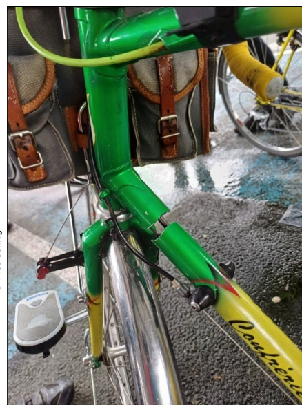
La fracture du tube diagonal !!
